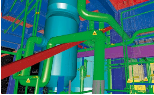
Die Funktion „Pipe Run“ modelliert nach Anklicken der geraden Rohrabschnitte automatisch einen zusammenhängenden Rohrverlauf mit allen Bögen in wenigen Sekunden.
