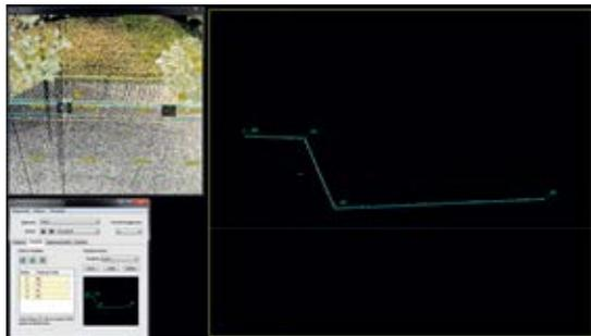
Las nuevas herramientas de Aligment /Station Manager con una vista en planta secundaria permiten crear fácilmente líneas de ruptura a partir de tablas de códigos.
